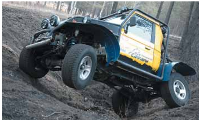
Артикуляция мостов не выдающаяся, преодоление «диагоналки» возложено на жесткие межколесные блокировки
