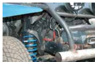
Пружины и амортизаторы фактически стандартные от LC
