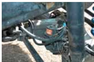
Межколесные блокировки принудительные с электрическим приводом
