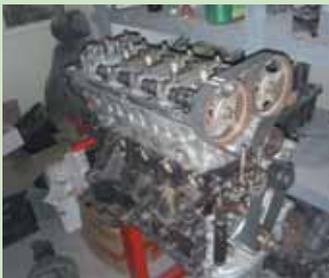
Причуды моторной архитектуры: блок двигателя от 1,5-литрового 4G91 практически идеально совместился с головкой от редкой 175-сильной модификации 1,6-литрового мотора 4G92 DOHC MIVEC
