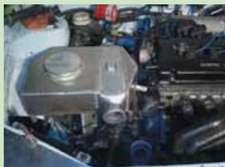
Вместо классического воздушно-интеркулера Константин придумал и изготовил собственную систему «вода-воздух» с емкостью для льда и принудительной циркуляцией жидкости
