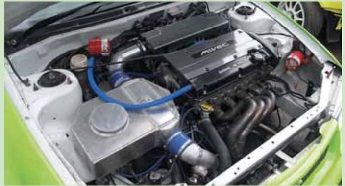
Менее объемный мотор и сам по себе смотрится под капотом Mirage Evo компактнее 2,0-литрового агрегата, а здесь еще и компоновка позволила «спрятать» турбину, окончательно скрыв злую сущность этого двигателя
