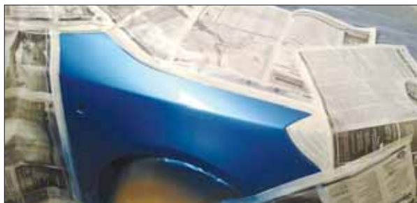
Окраска деталей стык требует не только мастерства маляра, но и колориста, подбирающего цвет — на стыке двух деталей даже незначительная разница в оттенке станет очевидной
