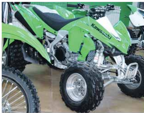
Kawasaki KFX 450 Cross — типичный представитель сугубо спортивных ATV: 450-кубовый мотор, механическая коробка и цепной привод на заднюю ось
