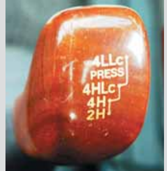
Задний привод, полный с блокировкой «центра» вискомуфтой, жесткая блокировка межосевого дифференциала и понижающая передача — трансмиссионный потенциал Delica, без изменений заимствованный у Pajero, под стать настоящему внедорожнику
