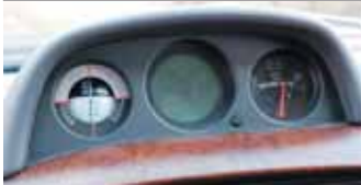
Наряду с «горизонтом» и вольтметром блок дополнительных приборов включает детектор парктроника
