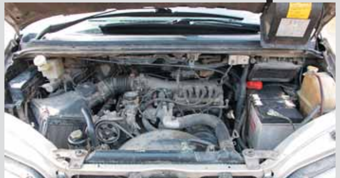
Основные проблемы с 6G72 связаны с компоновкой под капотом и шестью V-образными цилиндрами. Например, чтобы добраться до текущих сальников распределов, расположенных с тыльной стороны двигателя, нужно потрудиться. Замена свечей также требует приложения усилий
