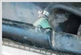
Расположенный сверху радиатора штуцер шланга расширительного бачка рано или поздно становится жертвой других ремонтных процедур
