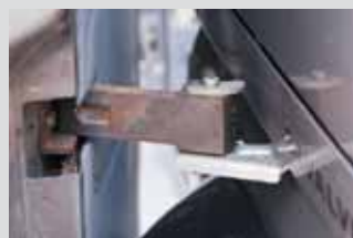
Чтобы сдвижная дверь не контактировала с одним из новых расширителей арок, пришлось изготовить оригинальный кронштейн
