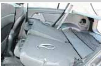
По трансформации ничего особенного: спинки раздельно просто ложатся на подушки, при этом с наклоном, причем разным
