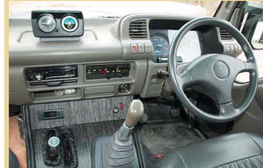
Баранка приспособлена от легковой Honda — при рулевом механизме от 5-тонного Нипо ее меньший диаметр не сказался на усилиях, зато управление с ней более острое и быстрее, чем у грузовиков
