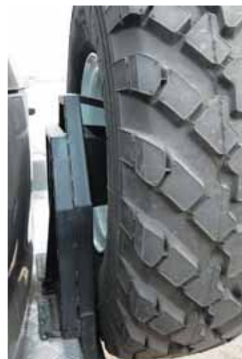
Колесо весит 80 кг, что заставило не раз укреплять кронштейн для запяски. Откидывается он вниз, что затрудняет доступ в багажник, но его цельную дверь в дальнейшем планируется переделать в более удобную двустороннюю
