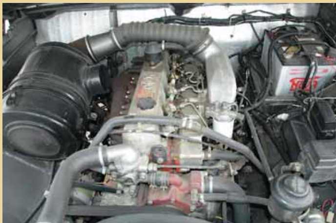
Огромный капот на газовых стойках открывает необъятный моторный отсек. Из неродного для 7,5-литрового дизеля Нипо здесь только система воздухоочистки — она позаимствована у КамАЗа. А конусный переходник к воздушному патрубку двигателя сделан из гильзы танкового снаряда!
