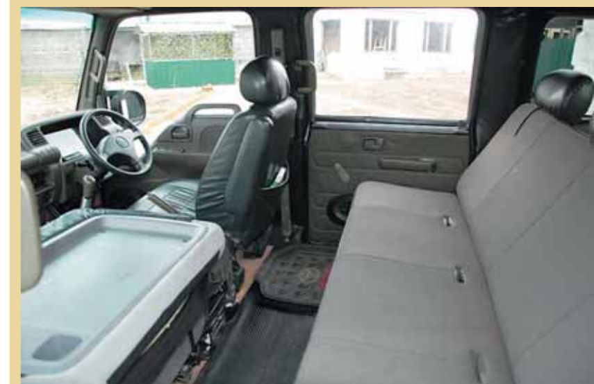
«Каюта» свободно размещает 3 человека сзади, не очень тесно и вчетвером, впереди двойное пассажирское сиденье от Ниссе, которое «крутится» и складывается в столик
