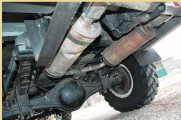
Раздвоенный выхлопной тракт не для пихонства — это понадобилось, чтобы вместо одной громоздкой использовать две компактные «банки» глушителей. Перед задним мостом совершенно незаметно размещен и дополнительно защищен 180-литровый бак от ЗИЛ-130
