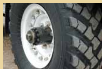
Колеса 66-го едва узнаются: диски «переклепаны» для расширения колеи, болты изготовлены из нержавейки, а шины — внедорожные КИ-115А в размере 12.00 R18, применяемые на «Тиграх». А еще передние ступицы самостоятельно переделаны с возможностью «отключения» колес
