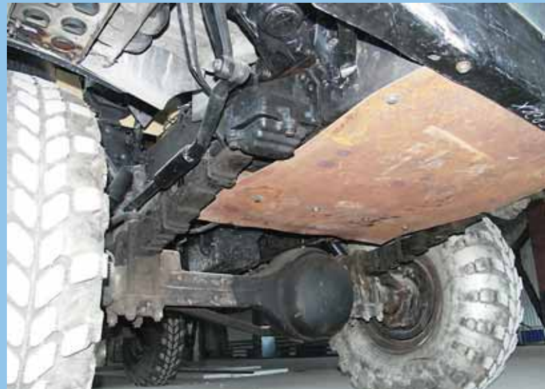
Полноприводное шасси с армейским прошлым и само по себе можно считать неубиваемым. Однако дополнительная защита для японского дизеля лишней тоже не будет
