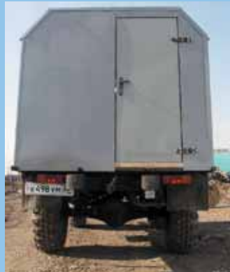
Армейские внедорожные шины еще больше увеличили дорожный просвет и общий потенциал машины на бездорожье
