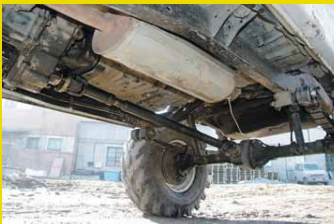
В подвеске у подготовленного к трофи-рейдам Rugged — гениальная простота: мост, рессоры, амортизаторы, и ничего более
