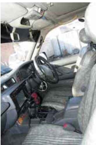
В кабине Land Cruiser целый набор дополнительных девайсов — начиная с DVD-магнитолы и заканчивая УКВ-радиостанцией. Кстати, сдвинутые вперед кресла — следствие разложенного сзади спального отсека
