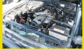
На 80-е Land Cruiser такую модификацию 4,2-литрового турбодизеля 1HD не устанавливали — этот двигатель заимствован с машины следующего поколения
