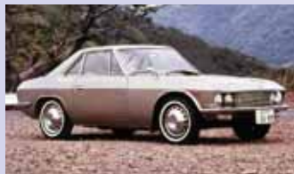
Первая Silvia была штучным изделием — выпустили менее 600 экземпляров, кузов выбивался вручную по деревянным болванкам
