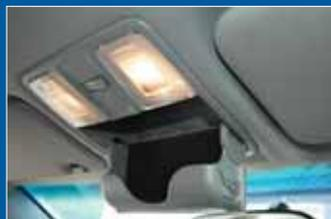
Раздельное освещение есть в базе, а вот очечник только в более дорогих версиях
