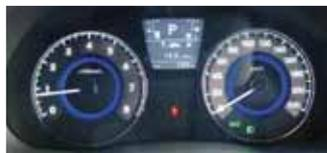
Приборы информативны, хотя их структура упрощена единым дисплеем для индикаторов уровня топлива, температуры двигателя, расхода топлива и показаний бортового компьютера
