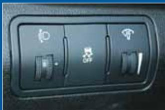
Система стабилизации отключаемая, яркость освещения приборов можно регулировать
