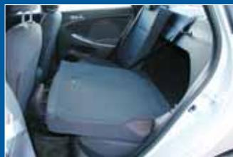
Раздельное складывание спинки (с выдвигаемыми подголовниками) предусматривает их откидывание на подушку сиденья — просто и быстро, но с полом багажника получается заметная ступенька
