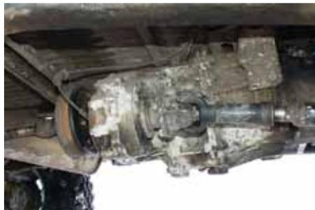
Коробка с «раздаткой» от Nissan Atlas при тюнинге УАЗов уже обычное решение. В данном случае она ничем не прикрыта — угол рампы при подобном лифте неплохой, а корпус блока чугунный. Стояночный тормоз выведен на карданный вал, все рабочие механизмы — дисковые
