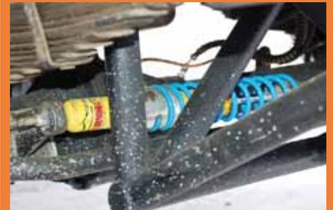
В рулевом, помимо гидроусилителя, используется демпфер Tough Dog. Амортизаторы заимствованы у «Соболя»
