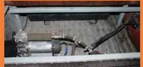
В задней части салона, под диваном расположены компрессор с ресивером и автономная печка (справа), работающая, естественно, на солярке
