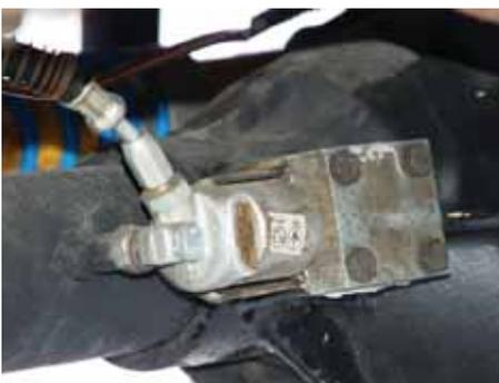
Созданные на основе камазовских деталей жесткие блокировки с пневмоприводом представляются наиболее надежными из всех существующих
