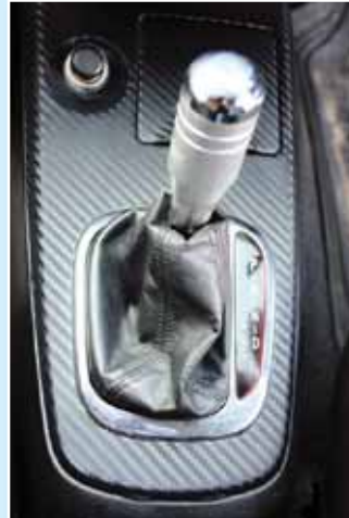
Пятиступенчатый «автомат» с честным ручным режимом достаточно надежен, но увлекаться силовым тюнингом двигателя не стоит. Хотя коробку также можно усилить, а правка «мозга» едва ли не обязательное условие для приятной езды
