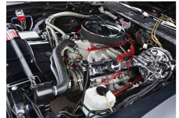
Под мощной плитой капота сокрыто настоящее американское сокровище — 7,5-литровый биг-блок о 400 лошадиных силах. Cutlass сейчас находится на финишной прямой по пути к становлению легендарным Oldsmobile 442. Эта аббревиатура означает 4-камерный карбюратор, 4-ступенчатая МКП, второй выхлоп. 2 пункта из 3 воплощены в реальность. Осталась лишь замена коробки передач.
