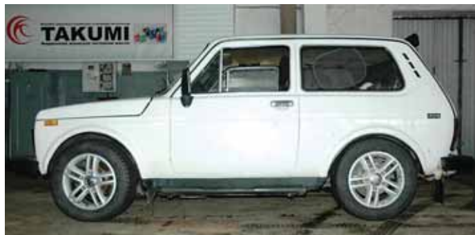
С пневмоподвеской между минимальным и максимальным положением кузова примерно 13-14 см, стандартный уровень находится чуть выше средней точки, а при максимуме кузов выше от заводского исполнения примерно на 4 см
