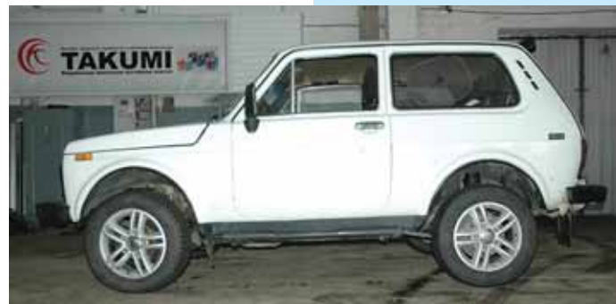
С пневмоподвеской между минимальным и максимальным положением кузова примерно 13-14 см, стандартный уровень находится чуть выше средней точки, а при максимуме кузов выше от заводского исполнения примерно на 4 см
