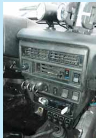
В салоне наличие 4-контурной пневмоподвески выдает только блок управляющих клавиш внизу центральной консоли и два указателя давления до 11 bar, каждый из которых раздельно «следит» за двумя колесами на оси
