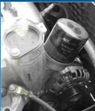
Масляный фильтр двигателя в верхней части — очень удобно для обслуживания. Только при смене надо быть аккуратным, чтобы не залить маслом приводной ремень
