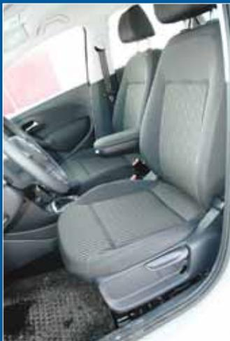
Удобным по профилю креслам с вертикальной регулировкой водительского в базе не хватает длины подушки и диапазона продольной регулировки — издержки класса
