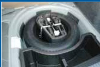
К багажнику разработчики подошли с повышенным интересом — очень вместительный, а под полом еще полноразмерная запаска и глубокая емкая ниша с удобным лотком для инструментов
