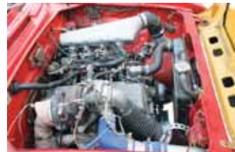
По силовой части, впуску, топливной системе и выпуску УЗАМ готов, хотя называть этот двигатель уфимским можно только отчасти. По сути, остались лишь блок, головка (кардинально доработанная), коленвал да часть навесного
