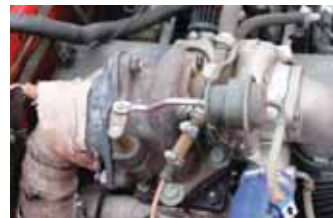
По турбине были разные варианты, в том числе от 3S-GTE и 4G63. В итоге были выбраны узлы от ниссановских 2,0- и 2,5-литровых «шестерок», но надежным оказался агрегат от субаровского EJ20
