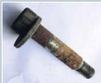
*Этим болтом с эксцентриком регулируются углы установки задних колёс. Внешность пугающая, но обычно такие не меняют. Второй болт практически не проржавел.*
