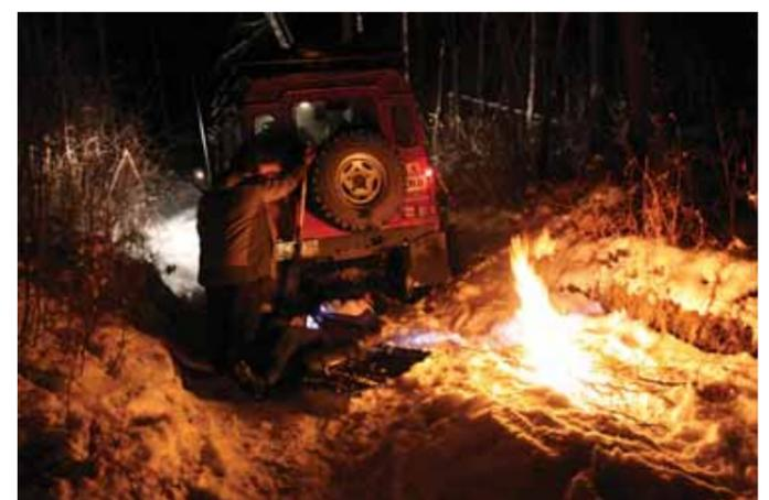
После нескольких километров пути по камням и кочкам среди бурелома был оторван задний левый амортизатор — ремонт пришлось проводить в полевых условиях при свете костра, на усиливающемся морозе
