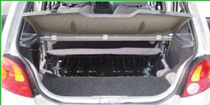
Подушка заднего сиденья сдвигается вперед и вверх, спинка откидывается, в результате получаем ровный пол. Объем багажника существенно увеличивается. Пользоваться этим удобно, да и довольно габаритные грузы можно перевозить
