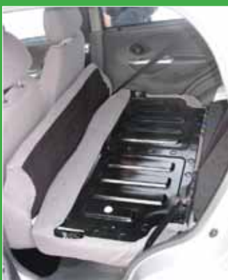
Подушка заднего сиденья сдвигается вперед и вверх, спинка откидывается, в результате получаем ровный пол. Объем багажника существенно увеличивается. Пользоваться этим удобно, да и довольно габаритные грузы можно перевозить
