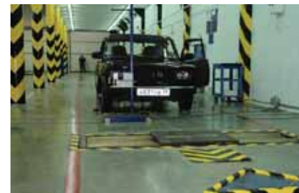
Регулировка света фар проверяется ре- глюскопом
