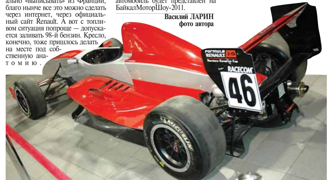
Дуга безопасности маскирует патрубок воздухозаборника и залипную горловину бензобака, кроме того, как один из самых прочных узлов болида в иных случаях выступает эвакуационный «скоб»
