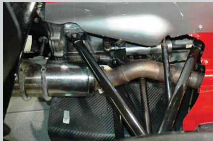
Двигатель Renault Sport развивает 210 л.с. при 7000 оборотах, и у него есть «нормальный» выхлопной тракт с прямоточным глушителем
