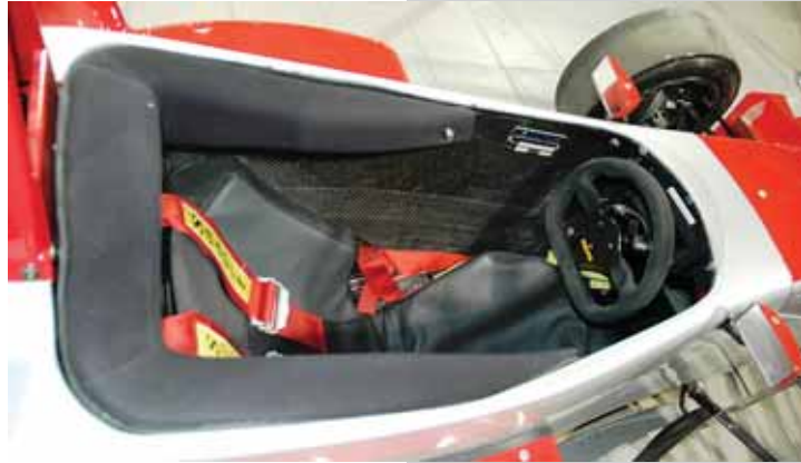
Ложемент изготавливался под себя уже в Иркутске, а вот четырехточечные ремни Sabelt, как и съемный руль Moto, предусмотрены в «базе»
