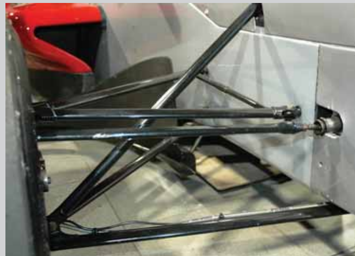
Открытые рычаги и тяги подвески, кроме того что позволяют быстро менять углы установки колес, имеют характерный «плоский» профиль в угоду лучшей аэродинамике
