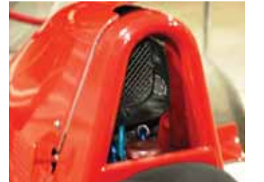
Дуга безопасности маскирует патрубок воздухозаборника и залипную горловину бензобака, кроме того, как один из самых прочных узлов болида в иных случаях выступает эвакуационный «скоб»
