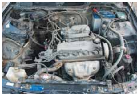
Под капотом (коробка еще не установлена) нет громких имен из мира тюнинга. Все очень скромно. 120-сильный ZC Сергей взбудрил только другими впуском и выпуском. Такой подход на фоне большинства проектов любителей и логичен. В драге или тем более в дрифте Integra участвовать не будет, а зачем в специфических условиях скользких покрытий турбина, запредельные обороты или мощные системы охлаждения?
