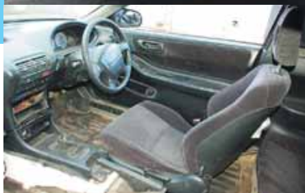
Здесь появится разве что анатомическое кресло (хотя родное сиденье Integra тоже неплохо держит тело). Остальной «тюнинг» свелся к выкидыванию ненужных салонных аксессуаров вроде лишних «диванов» и «ковров». Есть и облегченные двери с пластиковыми окнами
