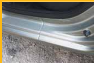
Сварной шов, идущий по порогу в проемах задних дверей (на фото слева), выглядит неэстетично и требует установки декоративных накладок — как это сделано спереди
