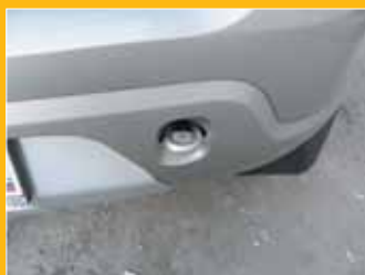
Фиксированная проушина пусть и бросается в глаза, зато не потеряется, да и так удобнее
