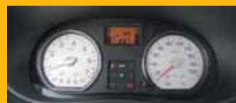
Ради удешевления в приборный щиток не стали добавлять отдельную «цепочку» указателей работы режимов АКПП: эту функцию вынесли на информационный экран — справа от указателя уровня топлива
