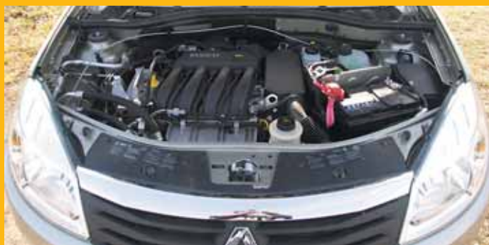
На «автоматических» версиях Logan и Sandero 16-клапанный 1,6-литровый двигатель выдает 103 л.с. — на 1 лошадиную силу больше, чем на машинах с МКП
