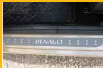
Сварной шов, идущий по порогу в проемах задних дверей (на фото слева), выглядит неэстетично и требует установки декоративных накладок — как это сделано спереди
