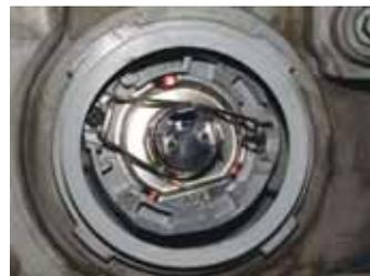
Положение цоколя лампы после обрезки усиков и установки в новом положении
