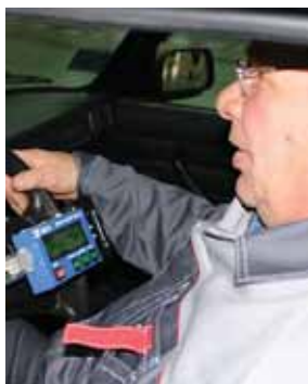
Проверка люфта в рулевом механизме
