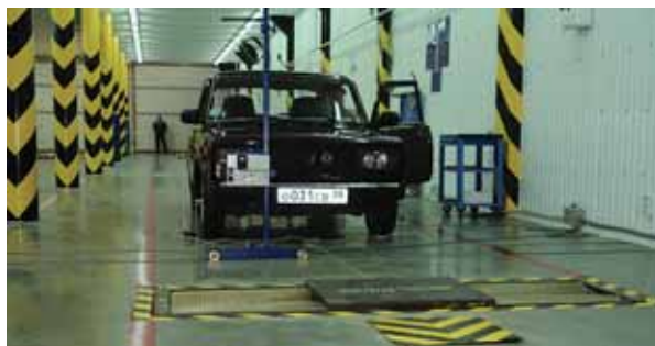
Регулировка света фар проверяется реглоскопом
